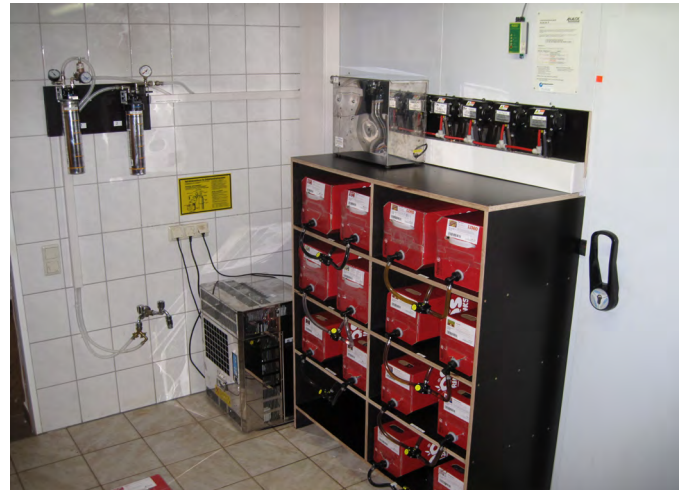
Postmixanlage mit Sirup-Regal und 10kg Bag-in-Boxen. Ausbeute der angeschlossenen Boxen auf dem Bild ca. 900Liter Fertiggetränk
